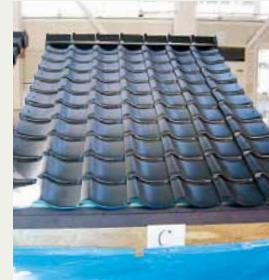
耐震性能試験((財)建材試験センター)
