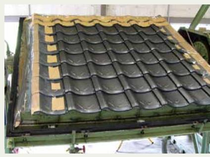
防水性能試験(愛知県三河工業試験場)
